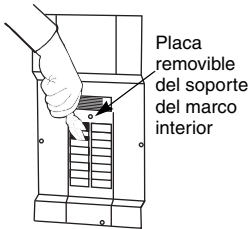
Figura 7: Extracción de las placas removibles
