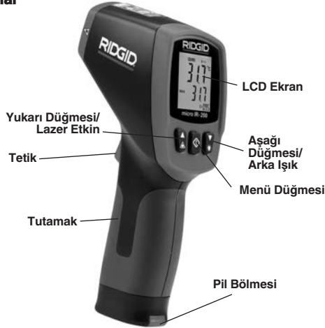
Şekil 2 – micro IR-200 Parçaları
