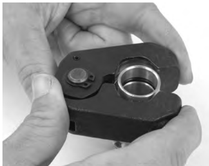
Figure 9 – Engagement de la bague de sertissage sur le raccord
