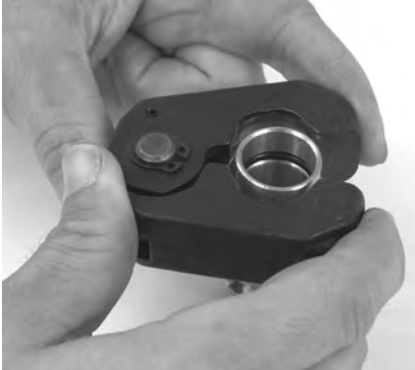
Рис. 9 – Установка обжимного кольца на фитинг
