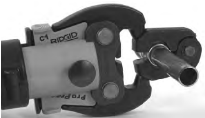
Abbildung 10 – Ansetzen des Stellantriebs am Pressing
