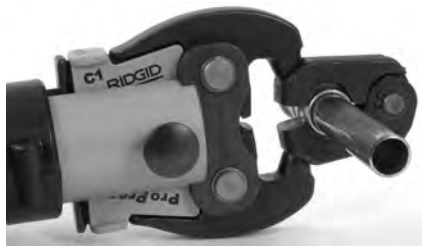
Figura 10 – Montaje del accionador en el aro sellador
