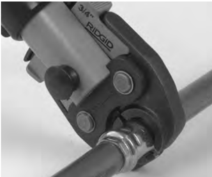
Abbildung 7 – Anbringen von Scherenbacken am Fitting
