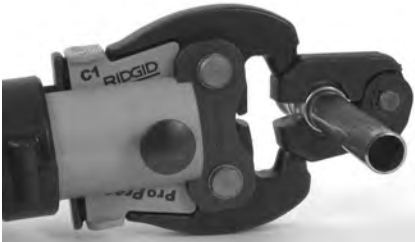
Рис. 10 – Крепление рабочей насадки на обжимном кольце
