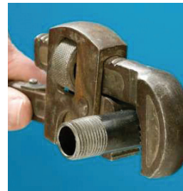
Black iron pipe (BIP)
